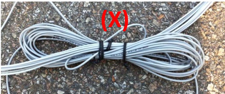
케이블 압착 및 굴곡으로 인한 손실증가 또는 광섬유단선 발생
